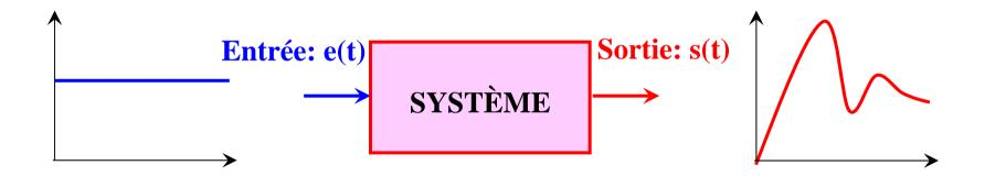
L'évolution de la sortie du système soumis à ces signaux type permettra de caractériser le système, et facilitera la comparaison des résultats obtenus.
